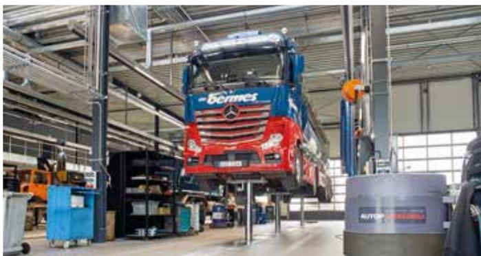
*Lkw-Werkstatt mit Stempelhebepöhlne für komplett beladene Sattelzüge bis 95 Tonnen.*
